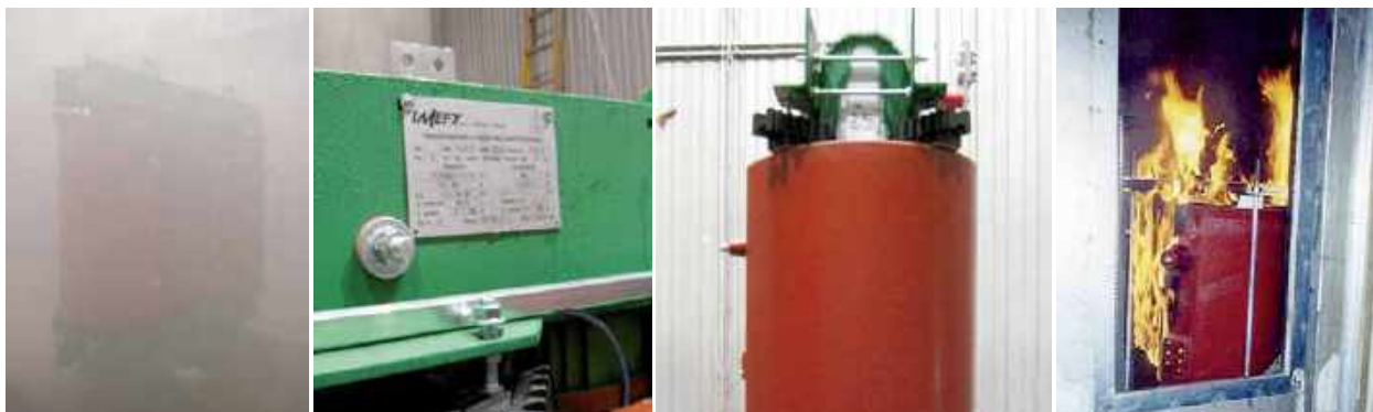
Nuestro transformador durante las pruebas E3 - E2 - C2 - F1
