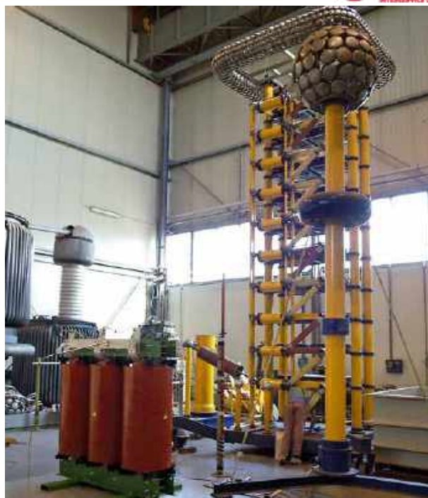
Lightning impulse test at CESI (MI)
