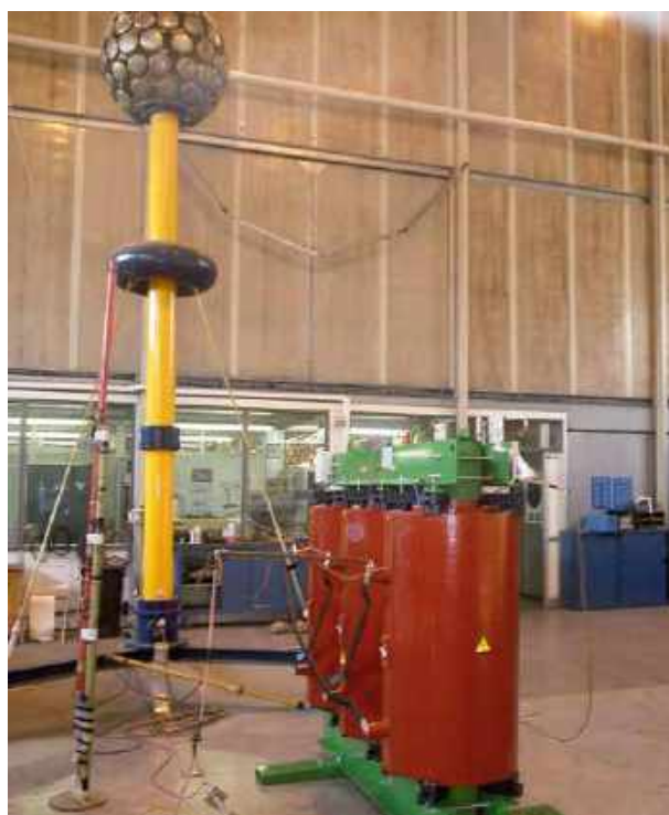
Lightning impulse test at CESI (MI)
