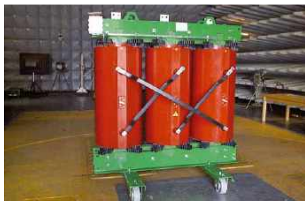
Noise level test at CESI (MI)
